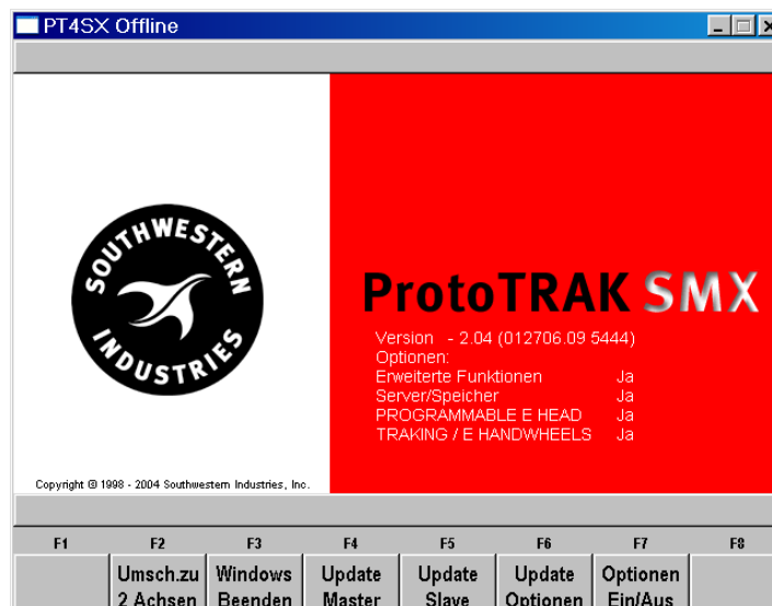
Bild 4.6 Diese Anzeige erscheint, wenn die Taste SYS gedrückt ist. Die Wahl „Umsch. zu 2 Achsen“ zeigt, dass die CNC gerade im 3 Achsen arbeitet.
